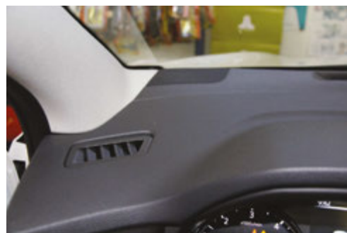
Il tweeter è presente in un alloggiamento alla base del parabrezza, una posizione non troppo felice per una installazione di riferimento.
