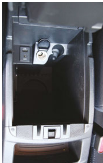
All'interno del vano portaoggetti nel bracciolo troviamo le porte USB e Aux, perfettamente replicate e funzionanti con la sorgente Macrom.
