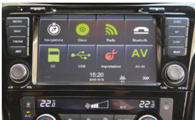
Le diverse sorgenti presenti nell'unità da plancia Macrom M-OF7060 installata nel cruscotto della Nissan Qashqai.
